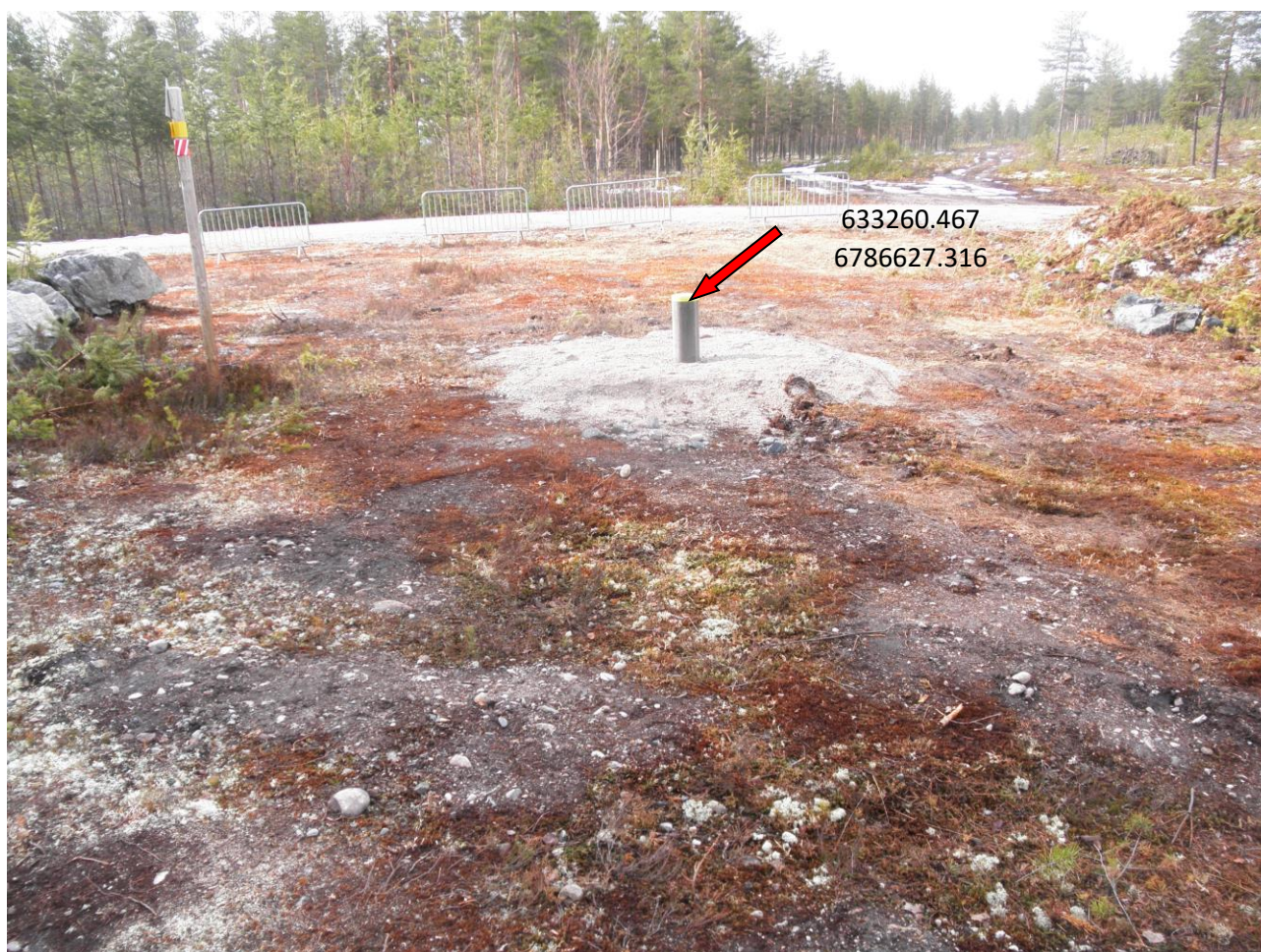
Fig. 2. Beliggenheten av borebrønnene ved grensen til vernesonen langs Løpsjøen. Pilen peker mot det ene brønnrøret. Koordinatene for brønnen er vist.
