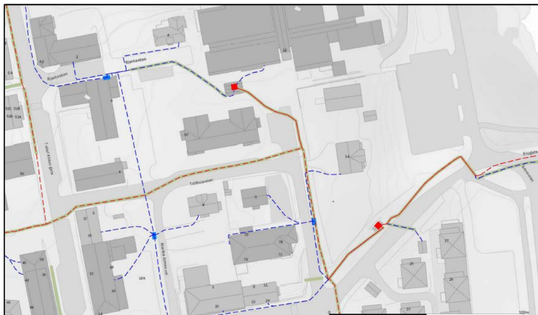
Illustrasjon av elanlegg i planområdet. Høyspent er vist med rødt, lavspent med blått og nettstasjoner/transformatorer er vist med røde firkanter.
