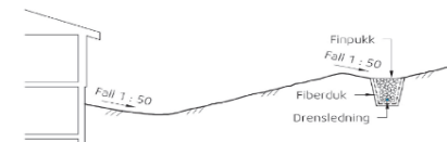
Figur 10- Eksempel på avskjærende grøft
