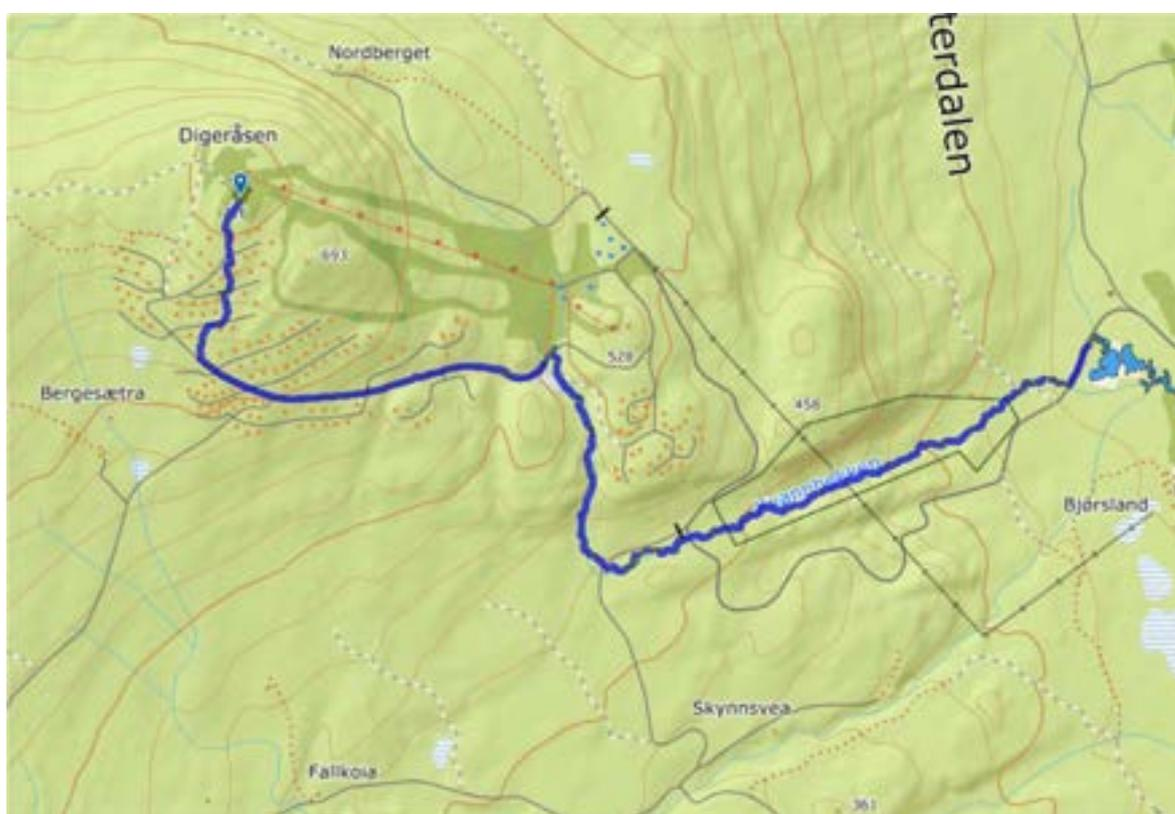
Figur 8. Illustrasjon av hvordan overvann fra øvre deler av Birkenåsen tar veien ned til Kvannbekken og etter hvert ned i Skynna.
