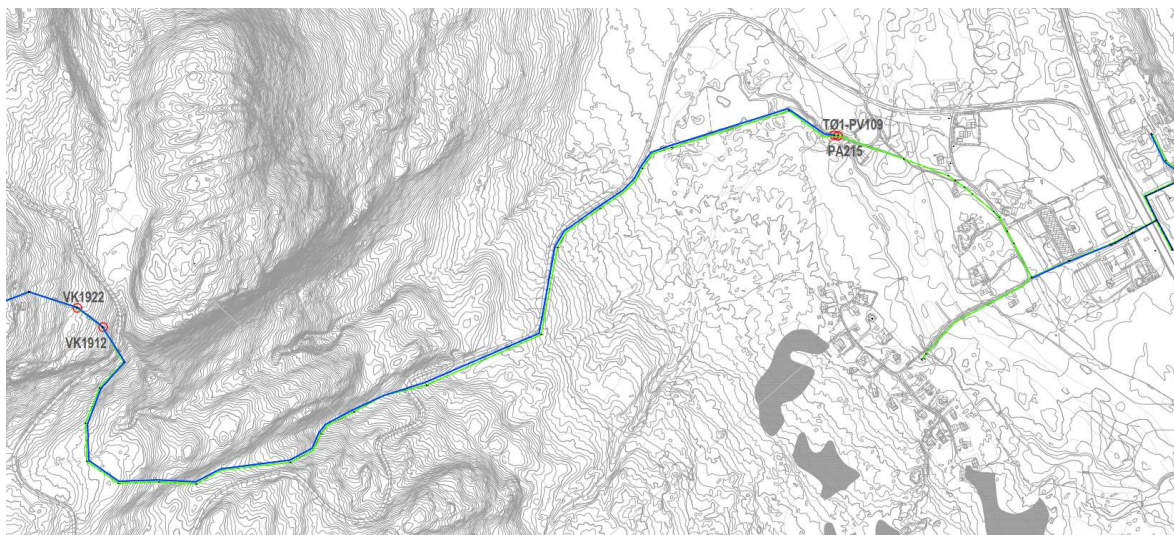
Figur 2. Kommunal vann- og avløpsledning, fra Hovdmoen/Sorknes Golf opp mot Birkenåsen
