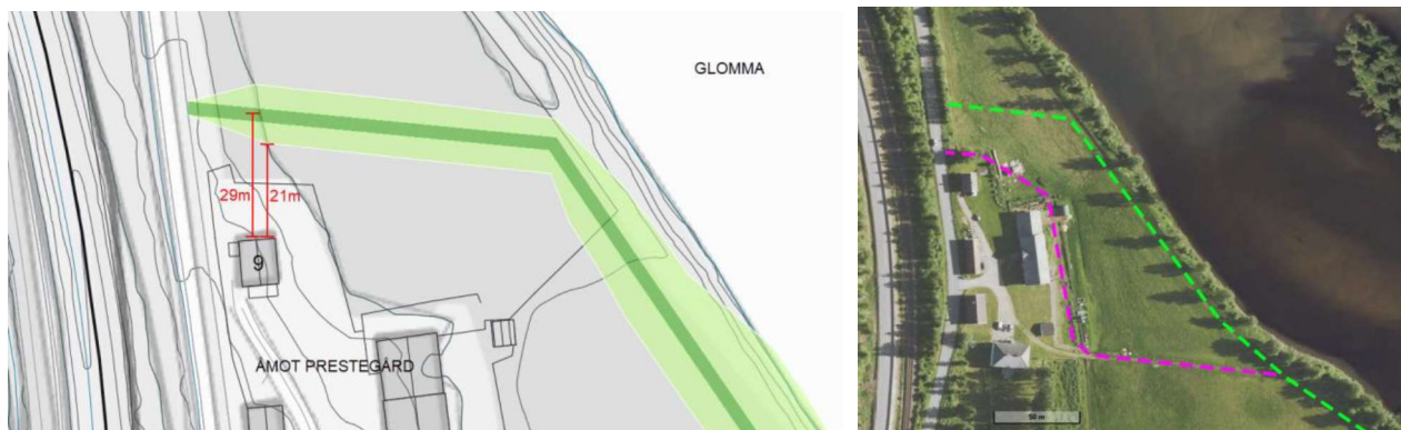
Figur 5-2 Venstre: Plassering av flomvollen (grønn) nord for Åmot Prestegård der den treffer riktig høyde på Koppangveien. Høyre: Alternativ plassering av flomvollen (rosa linje) langs eksisterende traktorvei og nærmere til Åmot Prestegård for å unngå inngrep i dyrkbar jord og kantsone.
