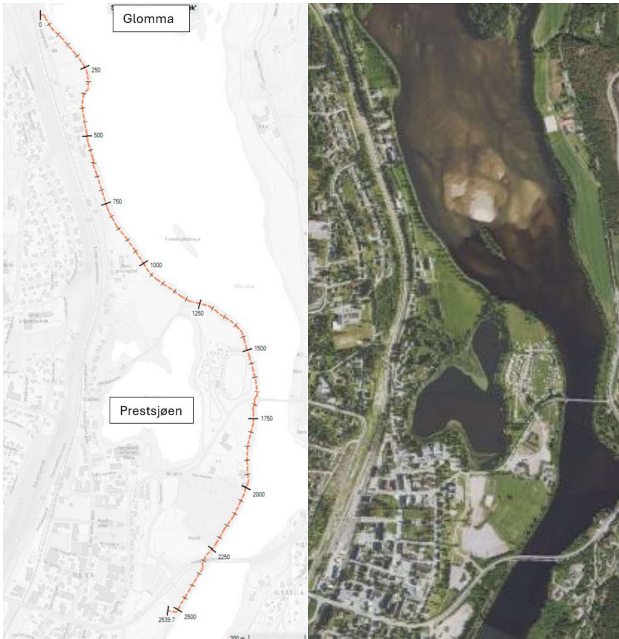
Figur 5-21 Lengdeprofil langs Glomma som er benyttet til å hente ut vannlinjer.
