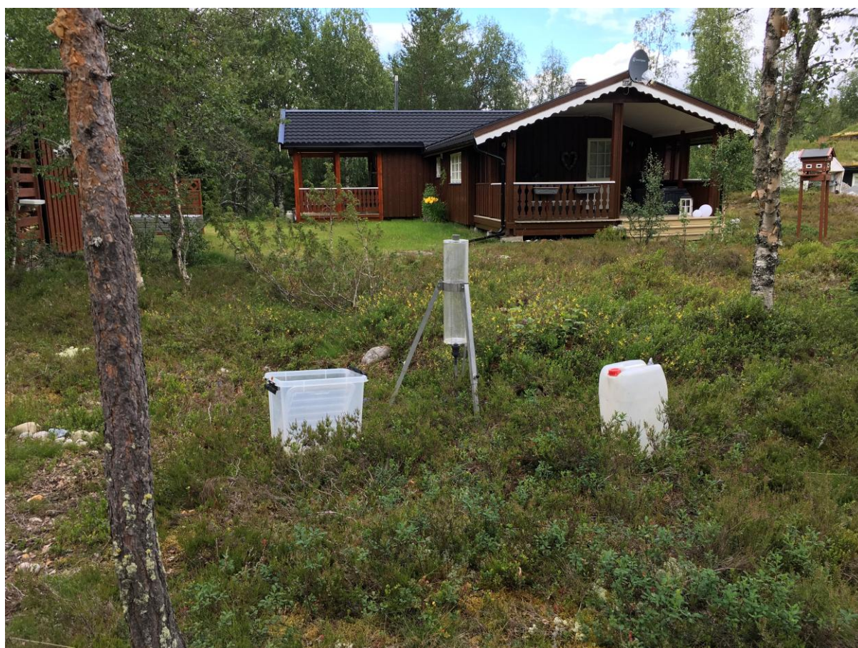
Synketest med infiltrometer i område.
